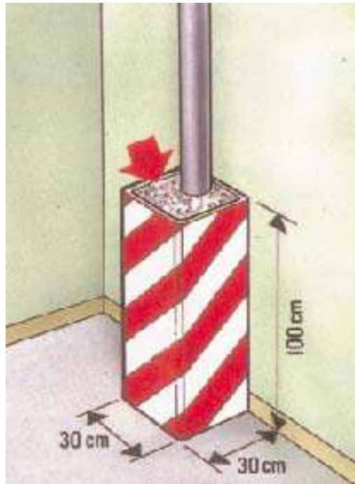
密封和保护建筑物内的屋面排水装置
