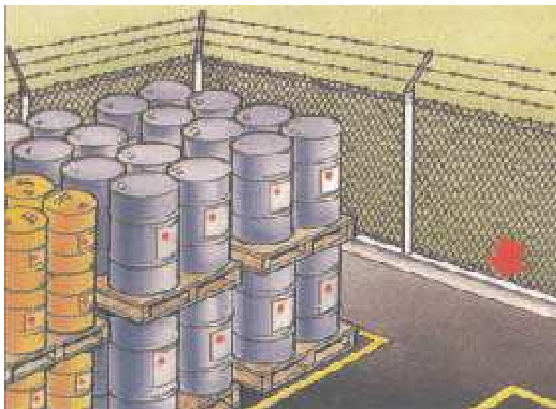
周边有基石环绕的稳固基地上的户外储存
