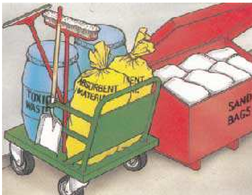
溢出物清理设备放在随手可及的地方
