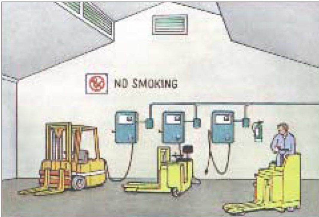
电池充电设施应远离储存的货物
