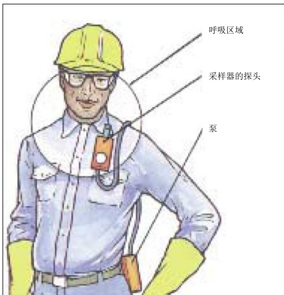
采样器的探头位于呼吸区域
