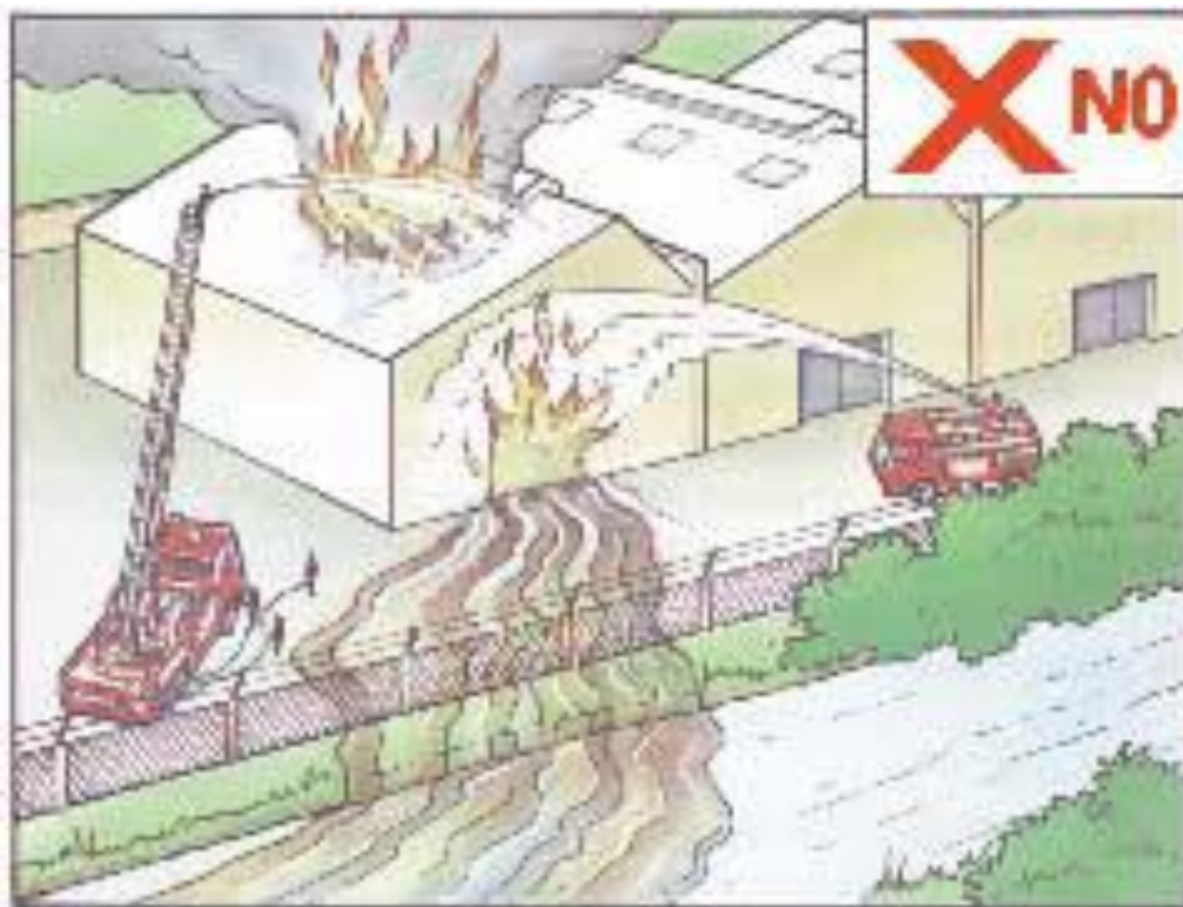
避免消防用水流失
