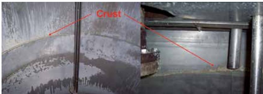
图4：目测检查一个反应釜的内部，如果发现仍有残留物，还需要要求进一步清洗。
