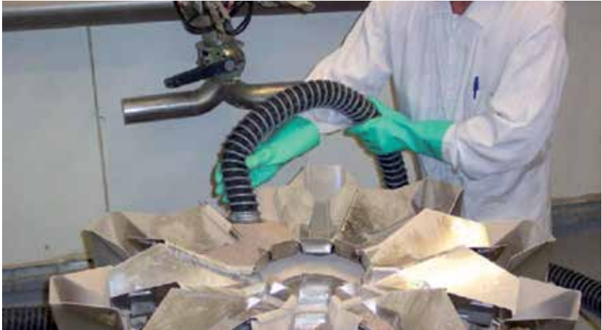
图9:用配备高效过滤器的特殊工业吸尘器来真空清除拆卸的包装设备部件上颗粒剂。
