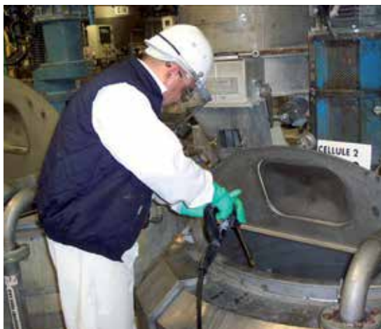
图8：用含有热水的高压清洗器来清洗反应釜。管道清洗喷嘴向前喷洒（一个喷射口）和向后喷洒（3个喷射口）喷射，通过拖动软管，甚至可垂直向上喷射。操作过程注意个人防护，避免高压热水喷溅到操作员身上。
