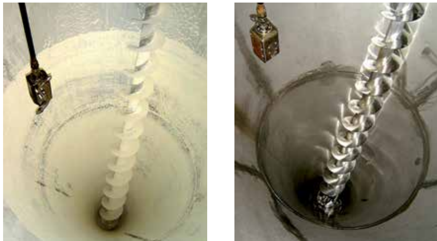
图5：使用旋转式喷头湿洗混合器内表面，清洗干燥前后对比图。
