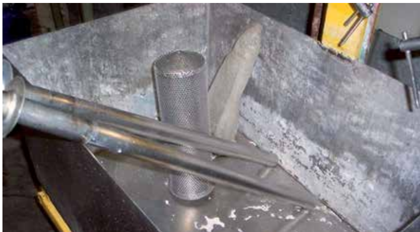
图7：用于机械或手工清洗（“刷洗”）拆卸小设备部件的工作台。
