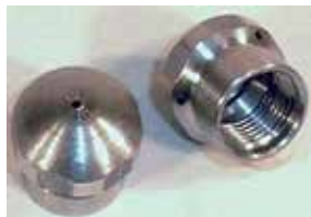
图8：用含有热水的高压清洗器来清洗反应釜。管道清洗喷嘴向前喷洒（一个喷射口）和向后喷洒（3个喷射口）喷射，通过拖动软管，甚至可垂直向上喷射。操作过程注意个人防护，避免高压热水喷溅到操作员身上。
