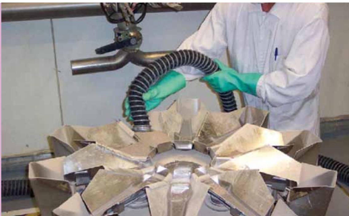
图9: 从部分拆除的包装设备上用特殊的配备高效过滤器的工业吸尘器真空清除颗粒剂
