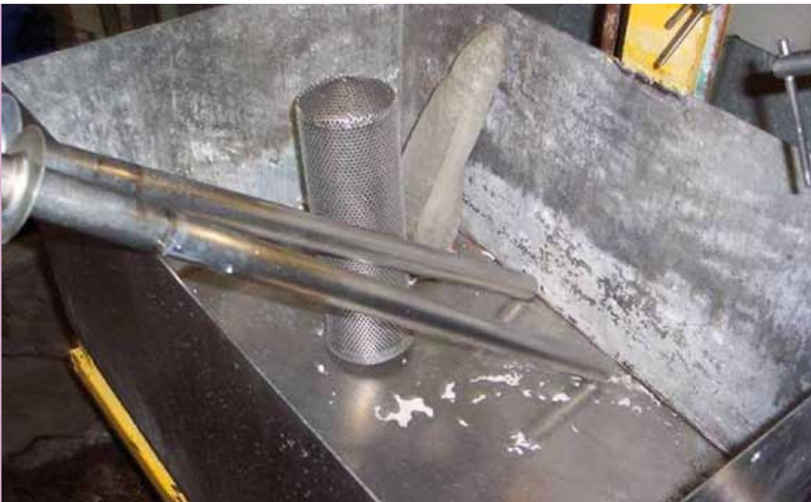
图7 用于机械或手工清洗（刷）拆下的小设备部件的工作台
