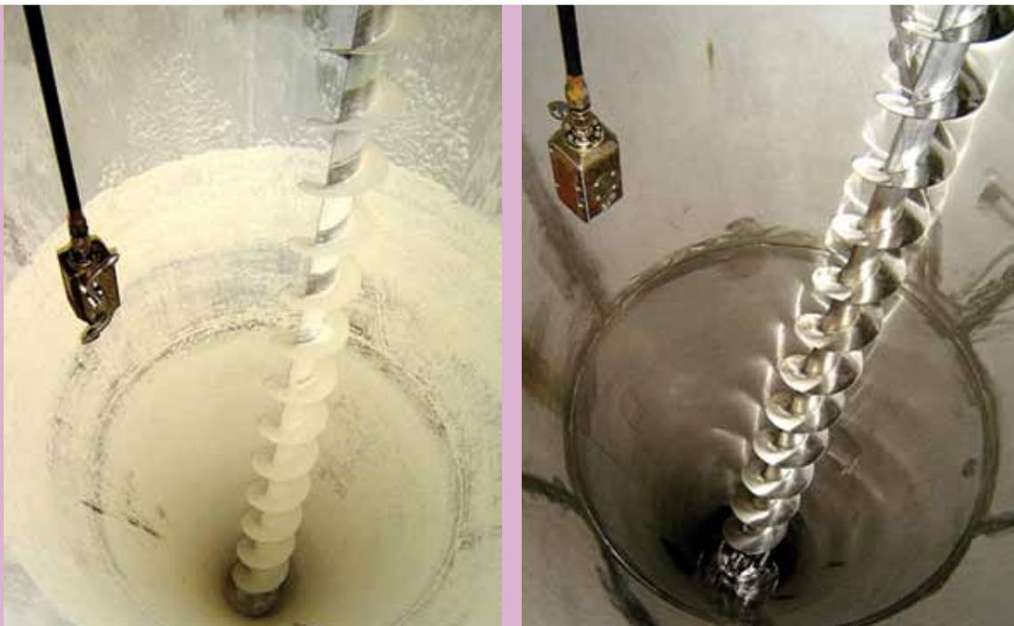
图5：混合器的内表面。清洗前的照片和经过转动喷头水洗干燥后的图片
